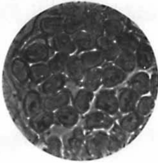
Fig. 1. Querschnitt der Lilienfeld - Seide. Vergrößerung 750. Hellfeldbeleuchtung.
